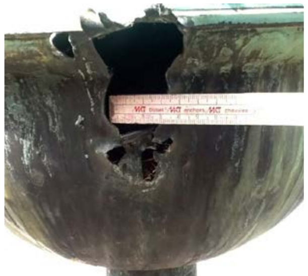
Die Kugel mit glattem Durchschuss, Löcher werden überarbeitet
