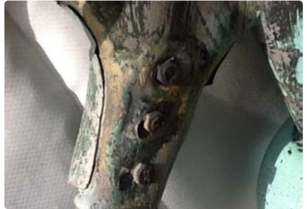
Eisenschrauben müssen ersetzt werden
