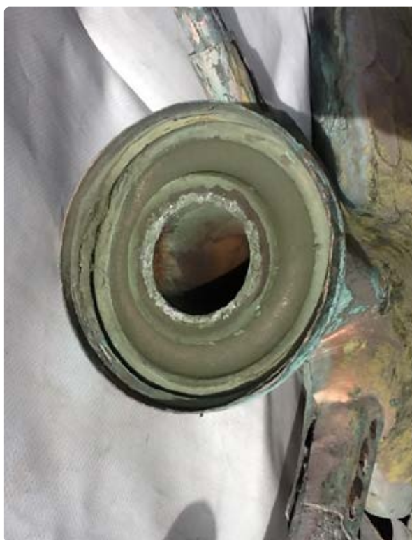
Das Lager hat erhebliche Schäden und ist neu anzufertigen
